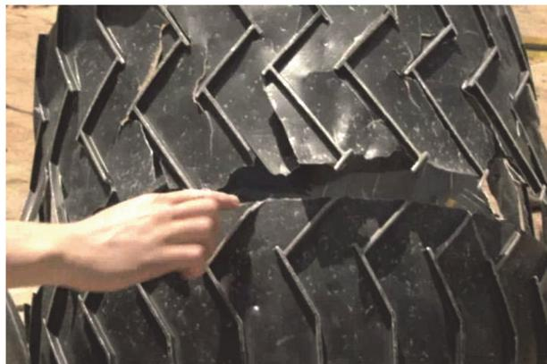
Рис. 13. Результаты испытания колеса марсохода Curiosity на каменистой поверхности
