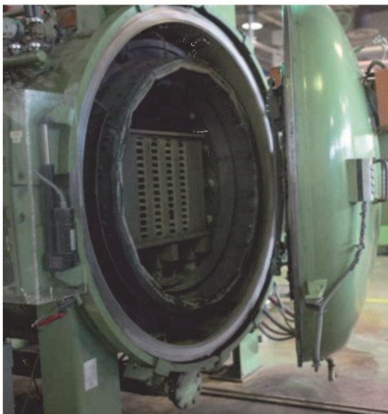
Рис. 13. Печь для спекания компании AFT Венгрия
