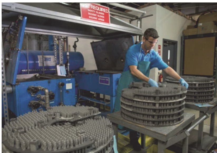
Рис. 12. MIM-детали, подготовленные для дебиндинга и спекания (фирма FloMet)
