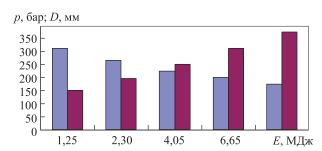
Рис. 6. Зависимость рабочих давлений p (■) и диаметров D (■) унифицированных ШБВД от запасенной энергии E
