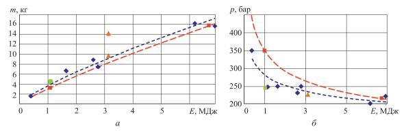
Рис. 1. Зависимости массы m (a) и рабочего давления p (b) от запасенной энергии b для ШБВД, выпускаемых различными производителями:
