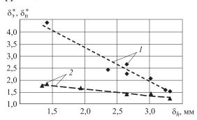
$Puc.\ 4.\$ Регрессионная зависимость относительной толщины в области экваториального  $\delta_3^*\ (1)$  и полярного  $\delta_\pi^*\ (2)$  швов от характеристической толщины  $\delta_h$  корпуса ШБВД: точки — статистические данные; кривые — аппроксимация
