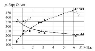
$Puc.\ 2.$  Корреляционная зависимость рабочего давления  $p\ (1)$  и диаметра  $D\ (2)$  ШБВД от запасенной энергии E: точки — статистические данные; кривые — аппроксимация
