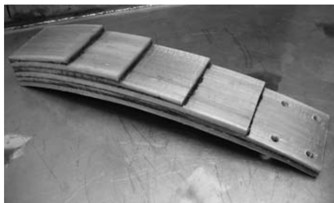
Рис. 3. Конструкция четверть-эллиптической рессоры
