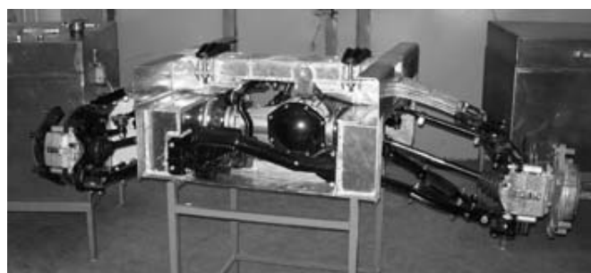
Рис. 2. Общий вид модуля системы поддрессирования ВТС «ЗЭТ 6×6»
