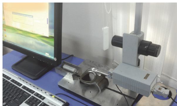
Рис. 4. Измерение шероховатости поверхности канавок, нарезанных на детали «Вкладыш ЗРК 004»
