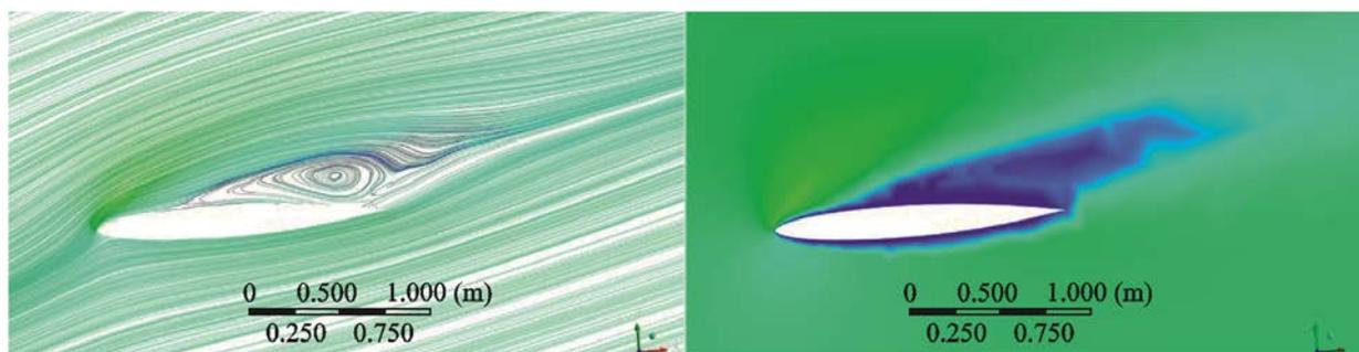
Рис. 8. Направление потока вблизи поверхности крыла:
