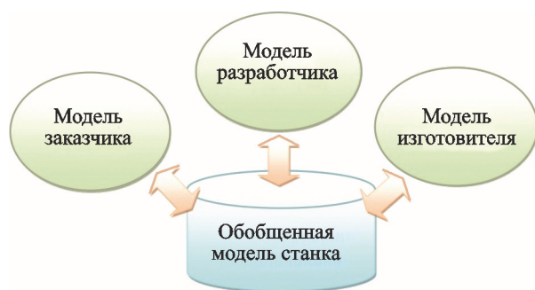
Рис. 2. Составляющие модели станка
