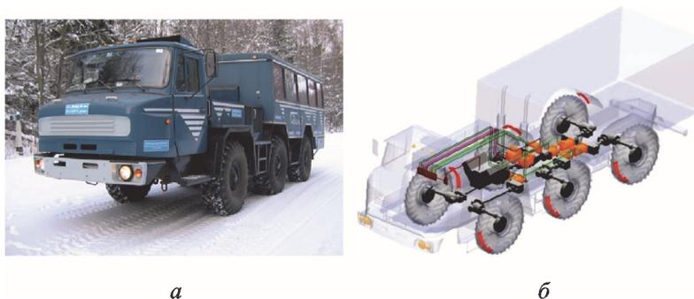
Рис. 4. Внешний вид (а) и конструктивная схема (б) автомобиля «Гидроход-49061»
