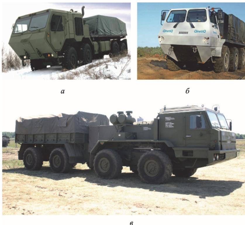
Рис. 3. Машины с электромеханической трансмиссией:
