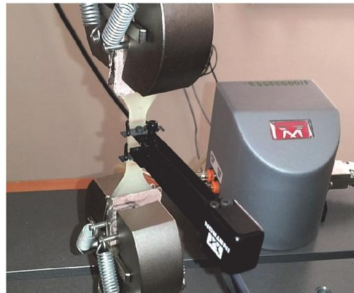
Рис. 6. Образец в захватах испытательной машины Instron Electropuls 1000 с установленным экстензометром
