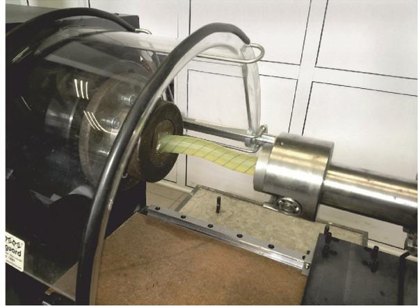
Рис. 4. Потеря устойчивости цилиндрического образца сплошного сечения при кручении
