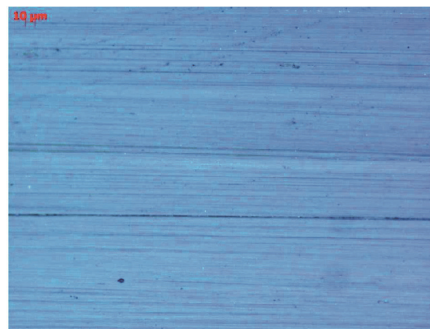
Рис. 6. Внешний вид обработанной поверхности заготовки из ситалла СО-115М (масштаб 100:1)
