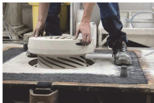
Рис. 7. Применение комбинированной технологии при изготовлении стальной отливки
