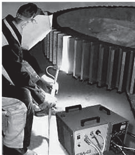
Рис. 5. Ручная закалка зубчатого колеса с помощью установки УДГЗ-200
