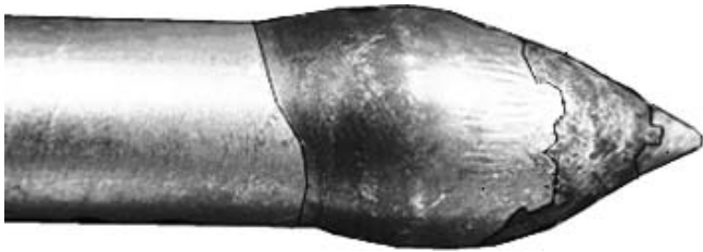
Рис. 3. Вольфрамовый электрод с налипшим материалом свариваемых деталей
