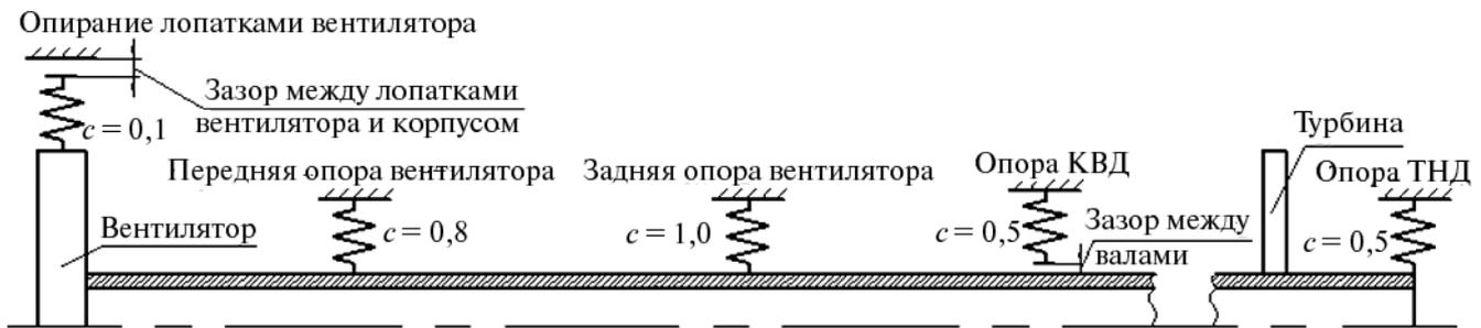
Рис. 4. Расчетная схема вала низкого давления
