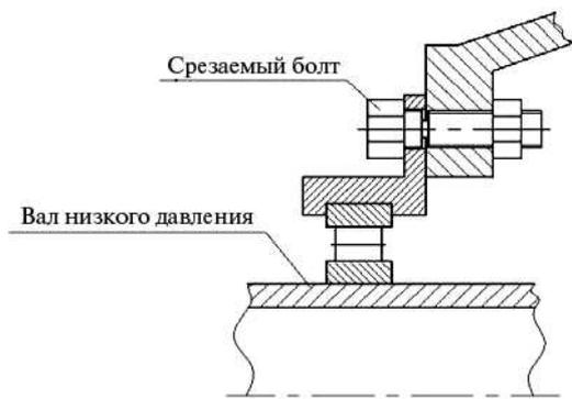
Рис. 2. Отсоединяемая опора вентилятора
