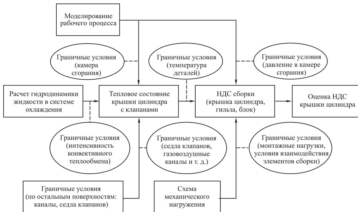
Рис. 1. Обобщенная блок-схема расчета крышки цилиндра
