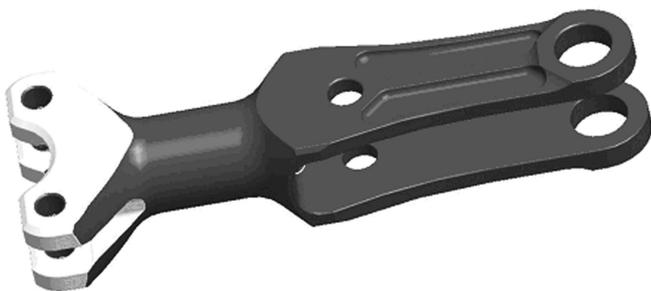
Рис. 4. Наконечник лопасти, выполненный из легированной стали
