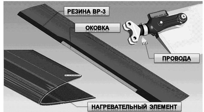
Рис. 5. Противообледенительное устройство
